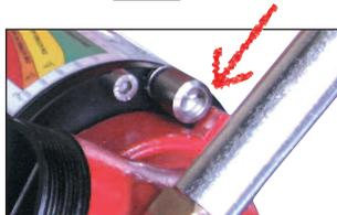
Manœuvrer le volant dans le sens anti-horaire pour arriver à proximité de la butée mobile de limitation à + 35°.
